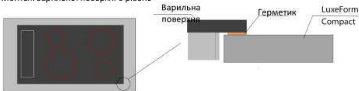
Монтаж варильної поверхні в напуск
